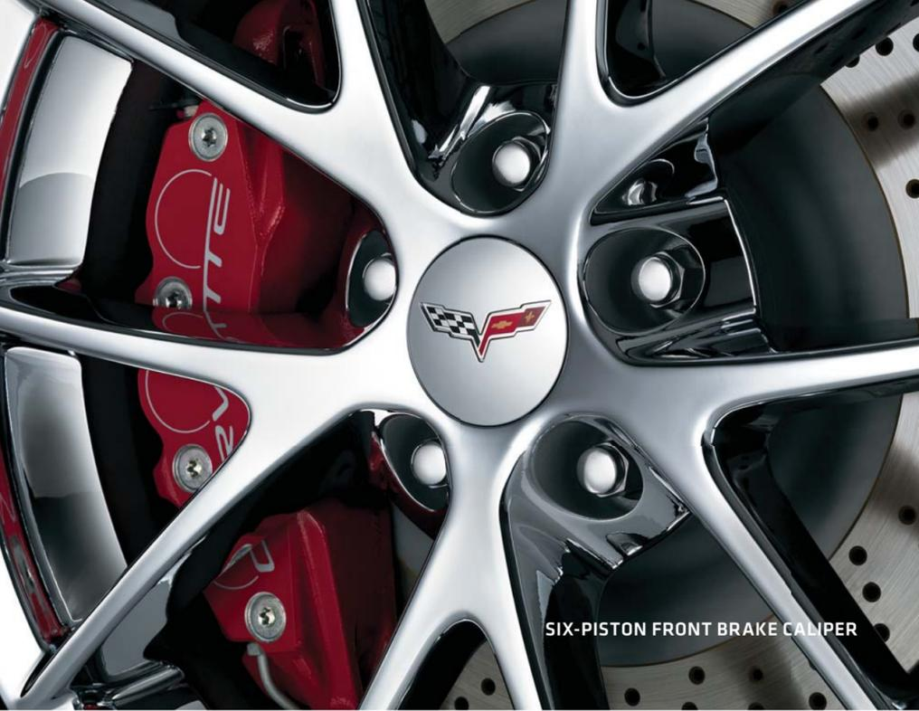
SIX-PISTON FRONT BRAKE CALIPER
