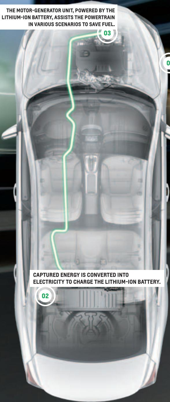
THE MOTOR-GENERATOR UNIT, POWERED BY THE LITHIUM-ION BATTERY, ASSISTS THE POWERTRAIN IN VARIOUS SCENARIOS TO SAVE FUEL.
